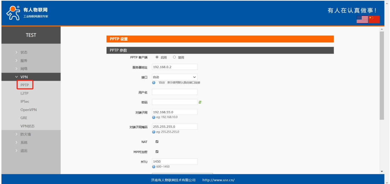
图 39 路由器添加 VPN 操作图一
