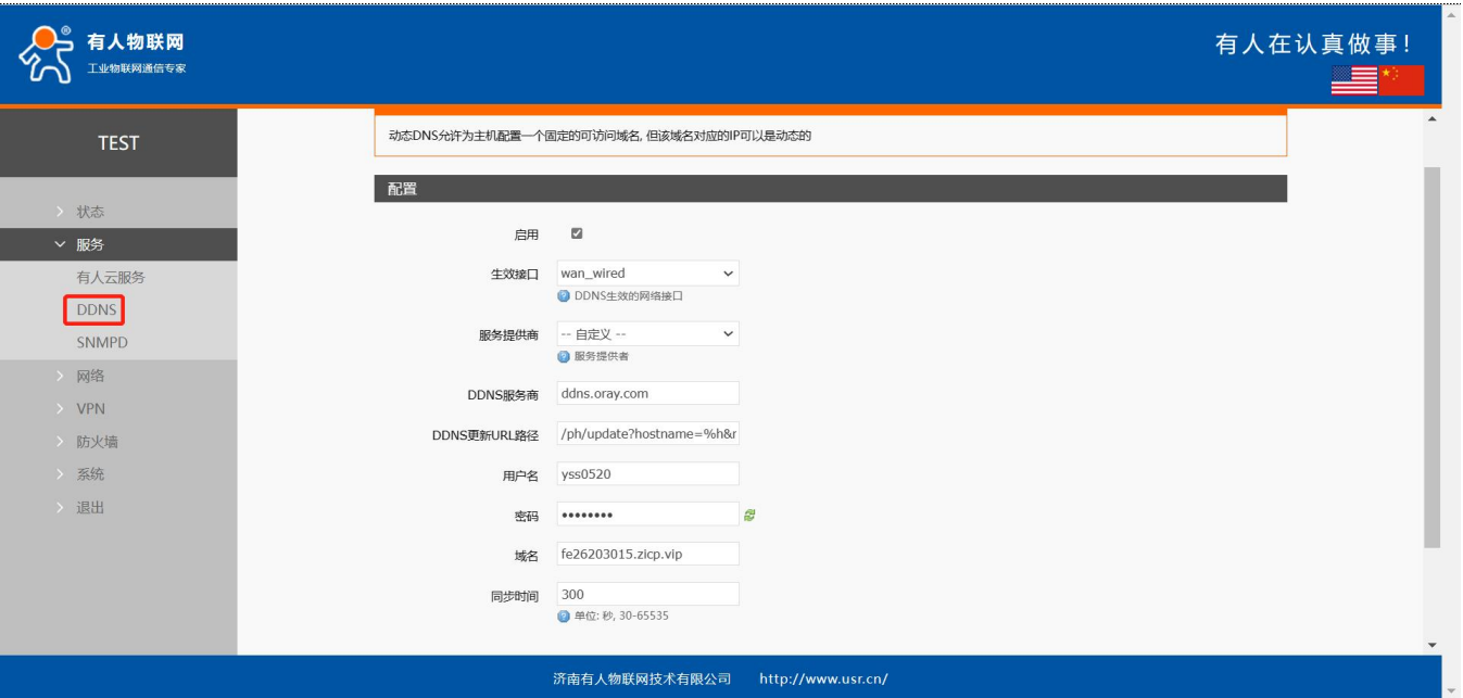
图 68 DDNS 自定义服务参数设置页面
