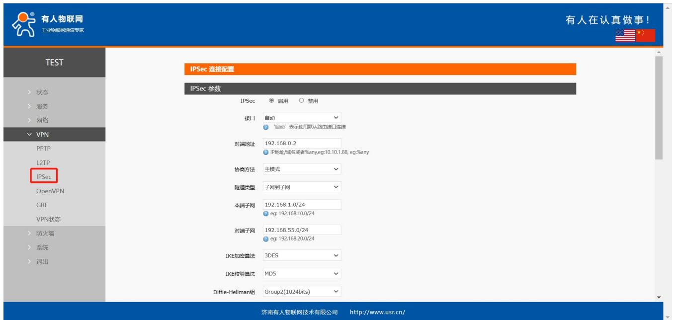
图 43 IPSec 启用后基本设置
